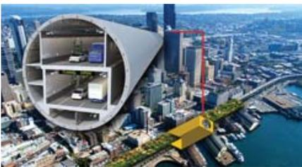
En Seattle, nos enfrentamos a retos técnicos complejos para la realización de un túnel de dos niveles que será perforado, en esta activa zona sísmica, con ayuda de la barrena más grande del mundo.
